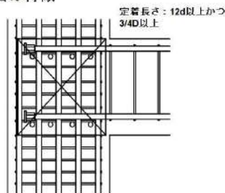
プレートナットを用いた定着
