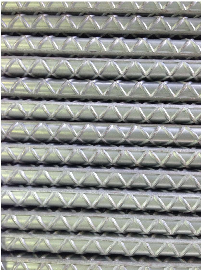
溶融亜鉛めっきが施された異形鉄筋。
